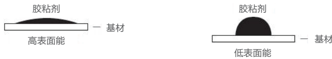
此图解展示了表面能对胶粘剂粘接性能的影响。高表面能材料会被更好地浸润，从而实现较高粘结强度。
